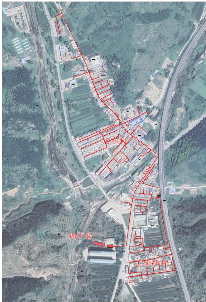
图 3-1 供热管网走向图
