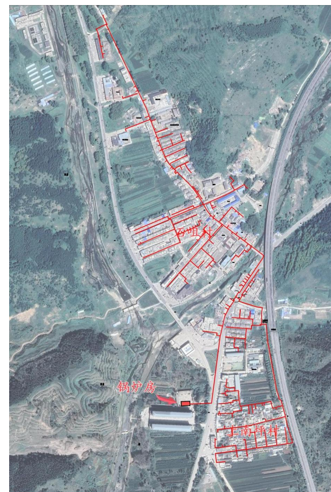
图 3-1 供热管网走向图
