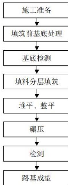
图 2-17 填筑路基施工工艺流程
